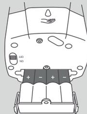
3. Coloque as pilhas no compartimento e encaixe a saboneteira no suporte;
