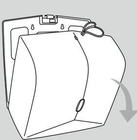
1. Pressione a trava com a chave plástica para abrir o equipamento;
