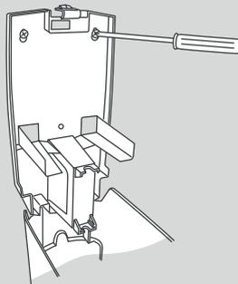
2. Remova o reservatório para fixar a saboneteira na parede.
