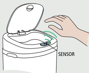
3. Para abrir a tampa, aproxime as mãos a 10~15cm do sensor. Ela permanecerá aberta por 6s e se fechará automaticamente se não houver interferências no sensor;
