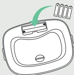
1. Coloque as pilhas no compartimento localizado na parte interna da tampa;
